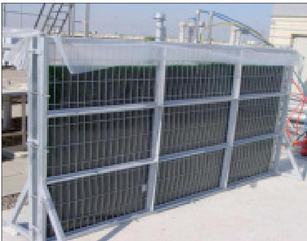
Fotobiorreactor vertical plano de 350 l, estanques abiertos de 100 y 300 l.
