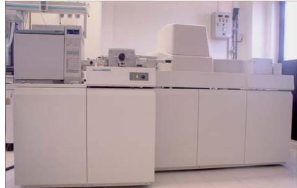
para discriminar entre masas muy similares. En la Figura 6 se observa un equipo acoplado HRGC/HRMS.
