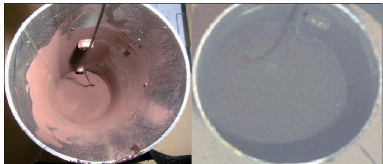
Fig. 14. Hematites roja inicial (izda.). Magnetita negra final (dcha.).
